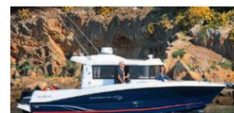
Nase kurzzeitig verloren. Wirtschaftlich ist man mit dem Testboot mit 2 x Mercury F 250 XL Verado rechnerisch bei 4000 U/min oder 24 kn unterwegs. Lässt man die beiden Motoren mit 4500 U/min laufen, bewegt man sich mit gut 27 kn durchs Wasser. Dabei gleitet der Rumpf am stabilsten und weichtest über die Wellen. Bei der von uns erreichten Höchstgeschwindigkeit von 39 kn zeigen die Drehzahlmesser 6200 U/min an. Eine Tankfüllung von 400-l-Benzin abzüglich
